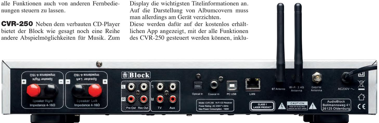
Die Lautsprecheranschlüsse sind clevererweise so beschriftet, dass sie sowohl von oben als auch von hinter dem Gerät ablesbar sind. Viele Anschlussmöglichkeiten machen den CVR-250 sehr flexibel einsetzbar
